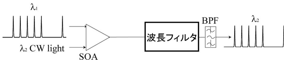
図 1.4 全光波長変換器
